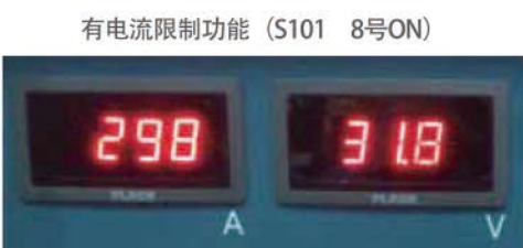
可将电流限制在300A以下
