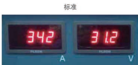
按照设定数值进行电流的输出
